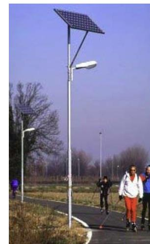
Figura 18 – Piste ciclabili – Esempio di illuminazione con pannelli solari
