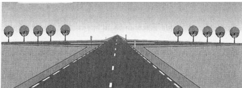
Figura 59 – Visualizzazione della strada secondaria mediante un allineamento trasversale
