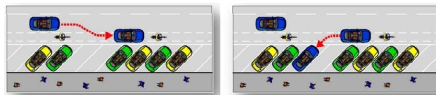
Figura 21 – Corsie ciclabili in relazione alla sosta veicolare
