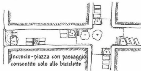
Incrocio nella zona a traffico moderato con al centro una minirotoratoria di bitume colorato o in pietra, semitransitabile, con altezza max di 5/7 cm. alla sommità
