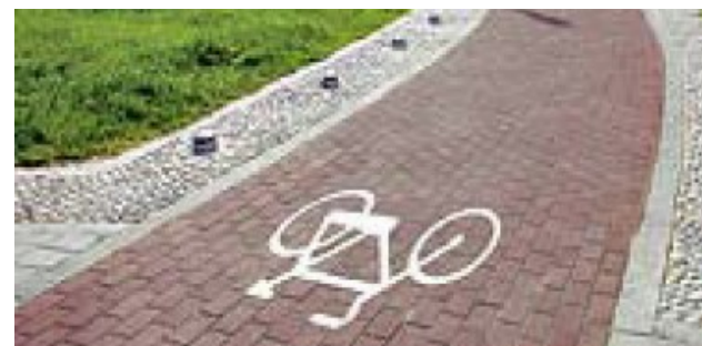
Foto 21 – Piste ciclabili – Pavimentazione in blocchetti di cls
