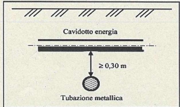
Nei percorsi **paralleli** tra cavidotti e tubazioni metalliche interrate deve essere mantenuta la maggiore distanza possibile. In ogni caso la distanza misurata in proiezione orizzontale tra le superfici affacciate delle due tubazioni deve essere di almeno 0,30 m.
