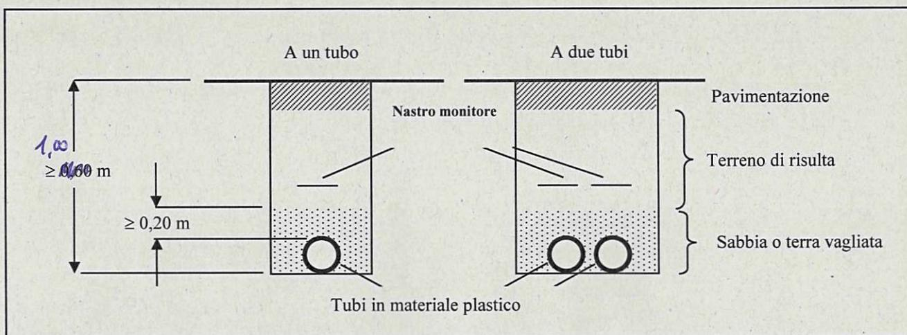
Canalizzazioni a profondità minore possono essere realizzate con tubo rinfiacato da un bauletto di calcestruzzo di spessore minimo 10 cm da ogni parte.
