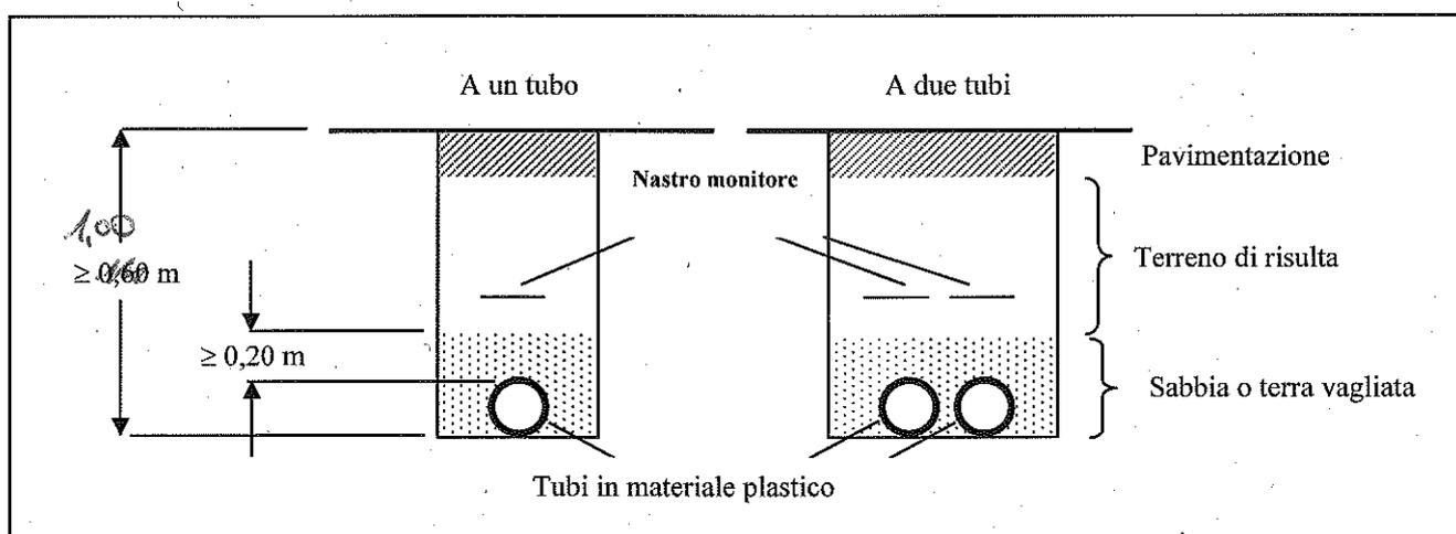
Canalizzazioni a profondità minore possono essere realizzate con tubo rinfiancato da un bauletto di calcestruzzo di spessore minimo 10 cm da ogni parte.
