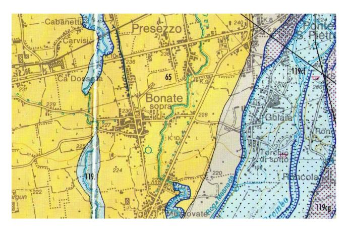
Lo studio geologico del PGT rileva la presenza di una falda piuttosto superficiale tra il canale ENEL e il Brembo. Infatti dalla stratigrafia del pozzo di via Bonzanni (Ghiaie quota 205 slm) si rileva soggiacenza (livello statico della falda) variabile fra quota 193 e 185.
