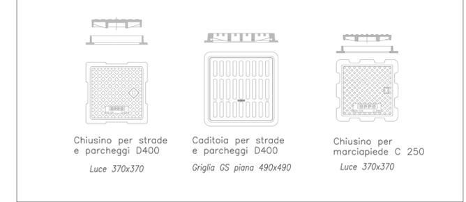
**PARTICOLARE CAMERETTA D'ISPEZIONE A PIANTA QUADRATA**
